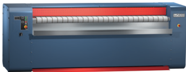
Figure : Repasseuse LACO D500, côté avant (introduction du linge)
