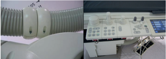
Abb. 1: Rillenzwischenräume und Schraubenvertiefungen sind nur schwer zu reinigen (links). Userinterface mit schwer zu reinigenden vertieften Tasten und Joysticks (rechts).
