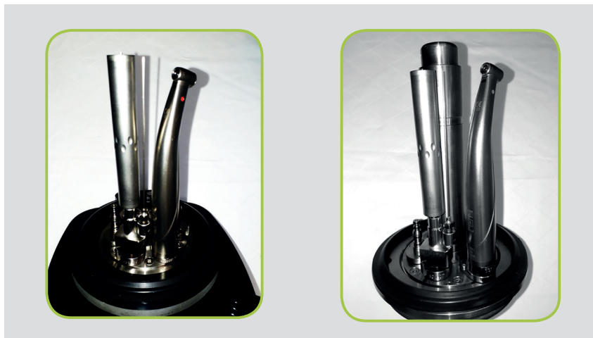
Abb. 2: Prüfadapter mit Prüfkörpern und real verschmutztes Instrument am MK IV.
