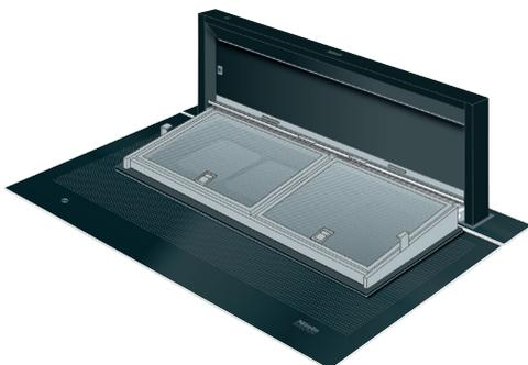
Les filtres à graisses métallique en inox à 10 couches sont situés derrière le panneau en verre. Ceux-ci sont insérés dans le panneau sur le bord, en biais. Le panneau est maintenu magnétiquement et doit être tiré vers l'avant, puis soulevé vers le haut pour l'ouvrir.
