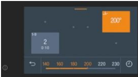
Foto 3: Leistungs- oder Temperatureinstellungen erfolgen komfortabel per Fingertipp auf dem mehrfarbigen TFT-Display. (Foto: Miele)
