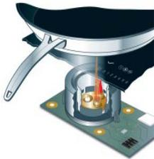
Für die neuen TempControl-Induktionskochfelder verwendet Miele Sensoren, die eine exakte Temperaturregelung ermöglichen. Beim Braten brennen Speisen so nicht mehr an. (Foto: Miele)
