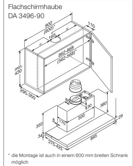
Detaillierte Einbauskizzen unter [www.miele.ch/einbauskizzen](http://www.miele.ch/einbauskizzen)
