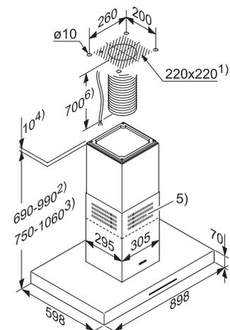
Detaillierte Einbauskizzen unter [www.miele.ch/einbauskizzen](http://www.miele.ch/einbauskizzen)
