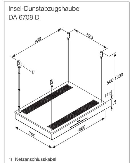
Detaillierte Einbauskizzen unter [www.miele.ch/einbauskizzen](http://www.miele.ch/einbauskizzen)
