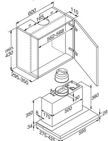
Detaillierte Einbauskiizzen unter [www.miele.ch/einbauskiizzen](http://www.miele.ch/einbauskiizzen)
