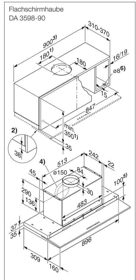
Detaillierte Einbauskitzen unter [www.miele.ch/einbauskitzen](http://www.miele.ch/einbauskitzen)
