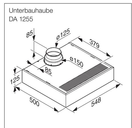
Detaillierte Einbauskizzen unter [www.miele.ch/einbauskizzen](http://www.miele.ch/einbauskizzen)
