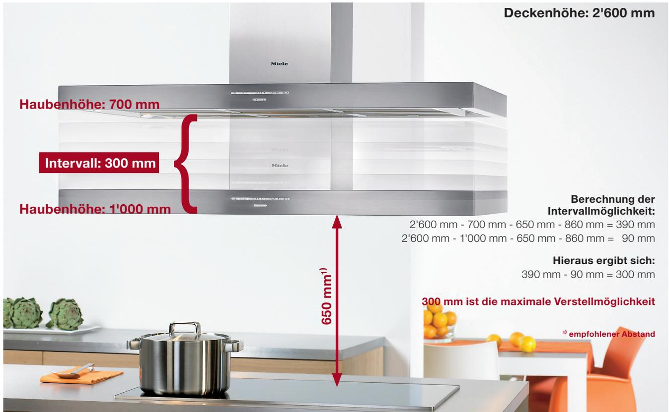
Maximale Intervallmöglichkeit bei Abluft und Umluft (in mm)
