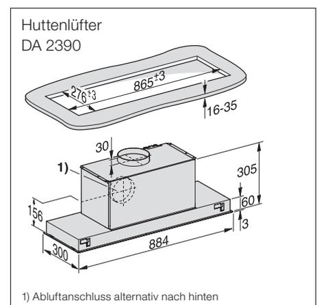
Detaillierte Einbausketzen unter [www.miele.ch/einbausketzen](http://www.miele.ch/einbausketzen)
