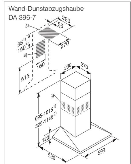
Detaillierte Einbauskitzen unter [www.miele.ch/einbauskitzen](http://www.miele.ch/einbauskitzen)
