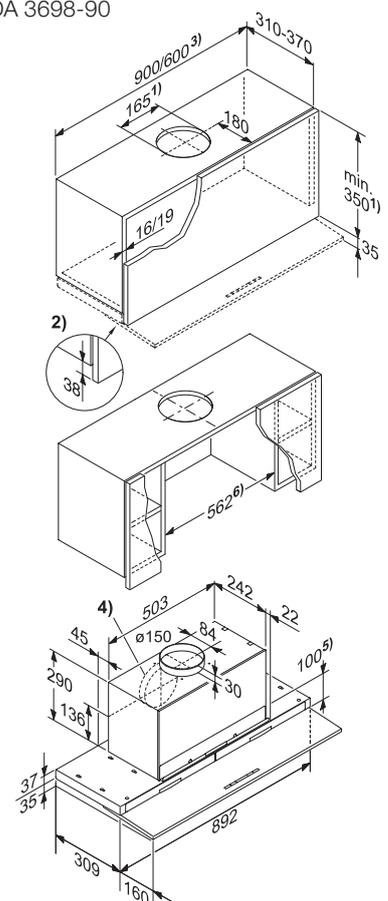
Detaillierte Einbausketze unter [www.miele.ch/einbausketzen](http://www.miele.ch/einbausketzen)
